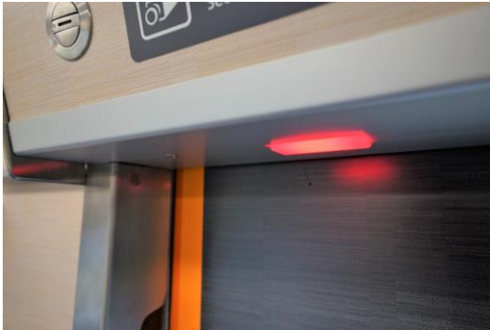
扉開閉予告灯
