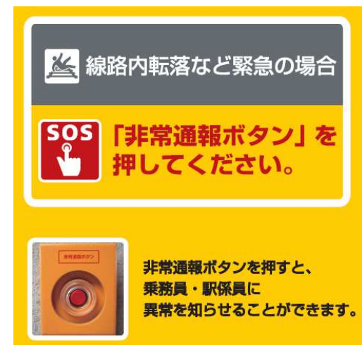
ホーム異常通報装置
