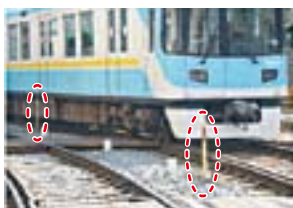
限界支障検知装置
