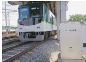
フラット検出装置
