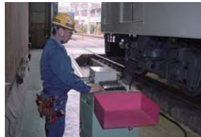
輪重測定装置による管理
