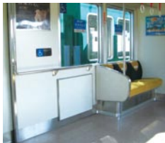
車いすスペース
