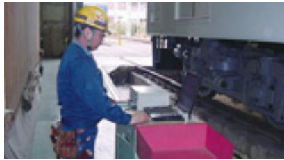
▲輪重測定装置
