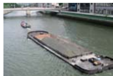
◀ 10トンダンプ約16台分の一般残土や泥土を、一度に運んだ土砂運搬船
