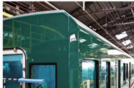
連結部分のカッティング。 オフセット衝突時のパワーを外へ逃がす効果がある
