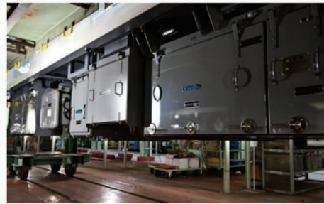
7000系以降の車両に採用されているVVVFインバータ制御。13000系では極低速域まで回生ブレーキを使用できる装置を搭載
