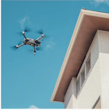
■屋根や外壁など、目視しにくい部分はドローンで撮影して広範囲にチェックします。
