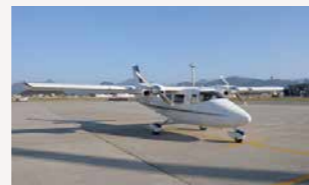
「CityMapper2」を搭載した計測用双発機
