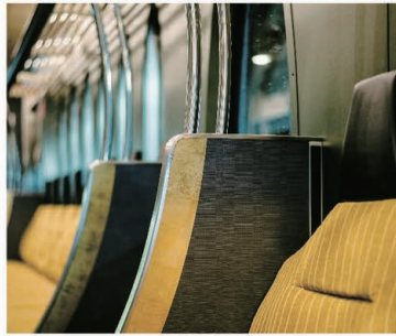
■袖仕切 座席の端部には大型の袖仕切を設置。万が一の衝撃時に備え、着席されるお客さまの安全性を向上
