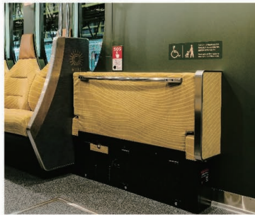
■車いす・ベビーカースペース 八瀬比叡山口側のドア付近のいすは折り畳み式でバリアフリーに対応
